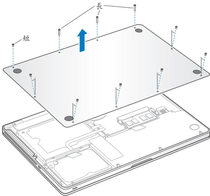
**【重要事項】** 當您取下底部機殼時，會暴露出較為脆弱的內部組件。當您取下或加裝硬碟機時，請避免觸碰到硬碟機組件以外的任何物件。
