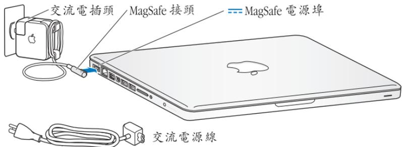
若要延長電源轉換器的接線長度，請使用交流電源線取代交流電插頭。首先，請向上拉出轉換器中的交流電插頭來將其取下，然後將隨附的交流電源線連接到轉換器上，並確定連接穩固。
