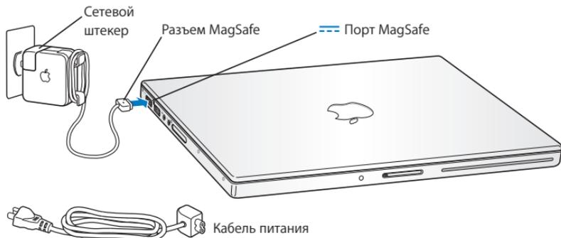
Перед подключением удлиняющего кабеля к адаптеру питания извлеките сетевой штекер из адаптера. Подсоедините кабель питания, входящий в комплект поставки, к адаптеру, убедившись, что он введен до упора. Вставьте другой конец кабеля в розетку питания. Кабель питания обеспечивает заземленное соединение.
