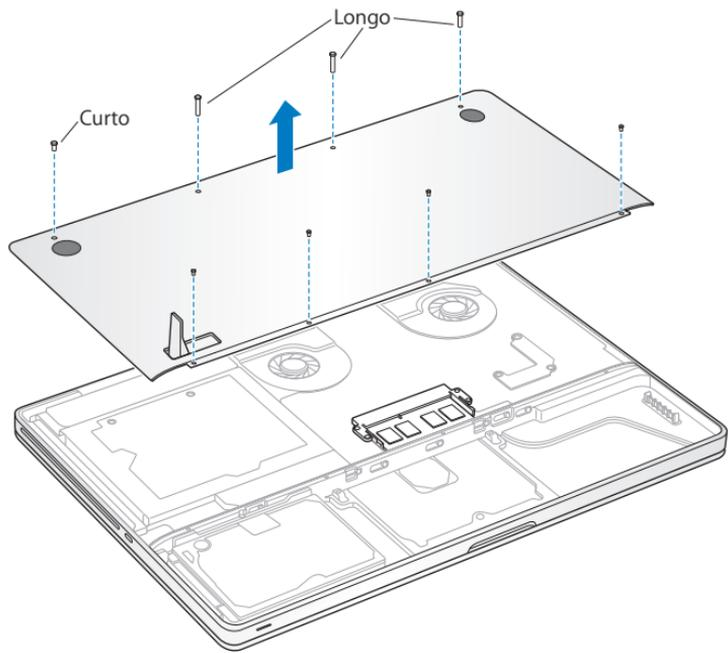
**Importante:** Ao remover o gabinete inferior, componentes internos sensíveis ficarão expostos. Evite tocar em qualquer outro componente que não seja o conjunto da memória ao remover e adicionar memória.
