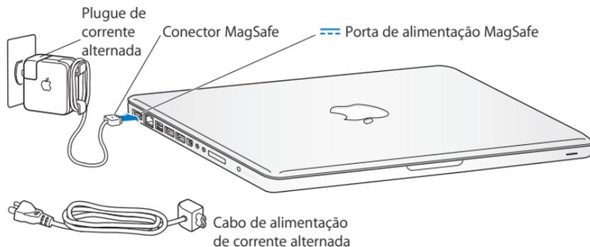
Para aumentar o alcance do seu adaptador de energia, substitua o plugue de corrente alternada por um cabo de corrente alternada. Primeiro, puxe o plugue para removê-lo do adaptador e, em seguida, conecte o cabo de corrente alternada ao adaptador, certificando-se de que esteja firmemente conectado.
