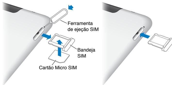
**Para abrir a bandeja do SIM:** Introduza a ponta da ferramenta de ejeção do SIM no orifício da bandeja do SIM. Pressione com firmeza, empurrando para dentro até que a bandeja salte para fora. Puxe a bandeja SIM para instalar ou substituir o cartão SIM. Se você não tiver uma ferramenta de ejeção do SIM, talvez você possa usar a ponta de um clipe de papel pequeno.
