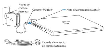
Para aumentar o alcance do seu adaptador de alimentação, primeiro puxe o plugue de corrente alternada para cima para removê-lo do adaptador. Conecte o cabo de corrente alternada fornecido ao adaptador, certificando-se de que esteja firmemente conectado. Conecte a outra extremidade a uma tomada elétrica. O cabo de corrente alternada fornece uma conexão aterrada.
