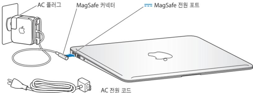
전원 어댑터의 길이를 확장하려면 AC 플러그를 포함한 AC 전원 코드로 교체하십시오. 먼저 AC 플러그를 위로 당겨 어댑터에서 제거한 다음, AC 전원 코드를 어댑터에 장착하여 단단히 고정되게 하십시오. 다른 한 쪽 끝을 전기 콘센트에 연결하십시오.
