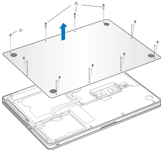
**重要：**底面カバーを取り外すと、取り扱いに注意を要する内部の部品が露出します。ハード・ディスク・ドライブの取り外しや追加を行うときは、ハードディスク以外の部分には触れないようにしてください。
