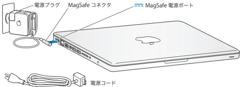
電源アダプタを延長するには、電源プラグの代わりに電源コードを使用します。まず電源プラグを上にも引っぱってアダプタから取り外し、それから付属の電源コードをアダプタに接続し、しっかり取り付けられていることを確認します。
