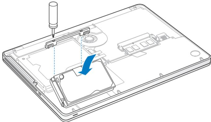
9 ブラケットを再度取り付けて、ねじを締めます。
