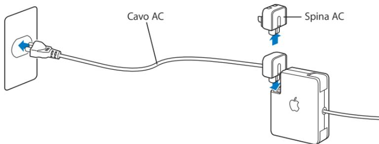
Per risultati ottimali, collegare sempre il cavo AC e utilizzare una presa con messa a terra, se disponibile. Utilizzare esclusivamente il cavo AC fornito con l'alimentatore. Assicurarsi di inserire completamente il connettore nella porta di alimentazione del computer per fare in modo che la corrente raggiunga il sistema. Se il cavo è posizionato correttamente, si accenderà una spia sull'estremità del cavo collegata a MacBook Pro.
