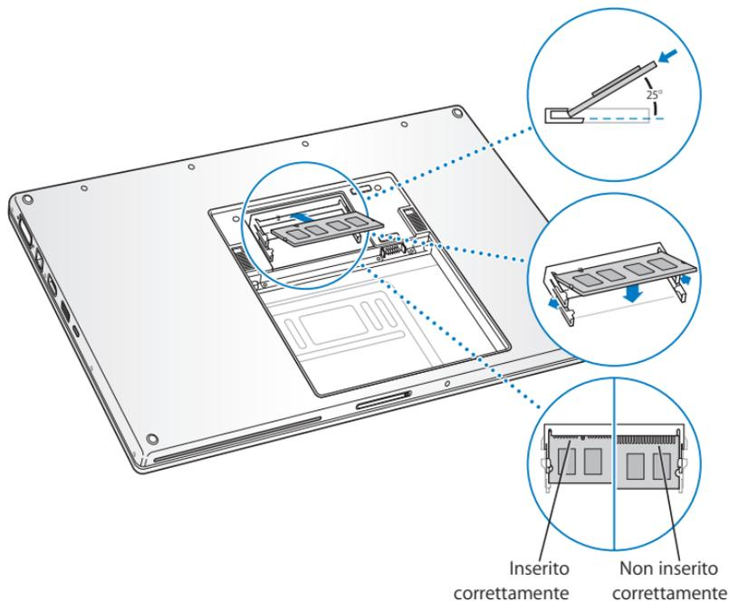
**Nota:** assicurarsi che la memoria sia installata secondo le istruzioni nell'illustrazione, dove i contatti dorati sono quasi completamente inseriti nel connettore.
