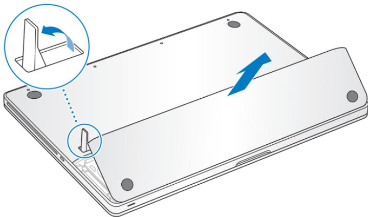
**Remarque :** le loquet doit être dans sa position ouverte pour pouvoir retirer ou replacer la batterie et le couvercle.
