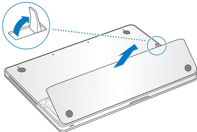
**Remarque :** le loquet doit être dans sa position ouverte pour pouvoir retirer ou replacer la batterie et le couvercle.
