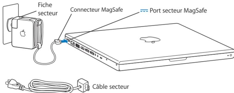
Pour rallonger le câble de l'adaptateur secteur, tirez d'abord sur la fiche secteur pour la retirer de l'adaptateur. Connectez le câble secteur inclus à l'adaptateur, en vous assurant qu'il est fermement connecté. Branchez l'autre extrémité sur une prise de courant. Le câble secteur fournit une connexion avec mise à la terre.
