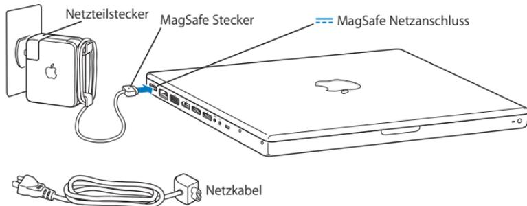
Bei Bedarf können Sie ein Verlängerungskabel an das Netzteil anschließen. Ziehen Sie dazu zuerst den Netzteilstecker nach oben vom Netzteil ab. Schließen Sie das beigegefügte Netzkabel an den Adapter an und vergewissern Sie sich, dass es korrekt sitzt. Verbinden Sie das andere Ende des Kabels mit dem Stromnetz. Der Computer ist über das Netzkabel geerdet.
