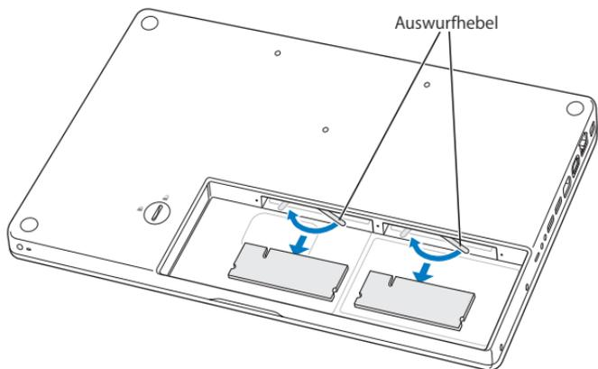
4 Setzen Sie die neuen Speichermodule in die Steckplätze ein:
